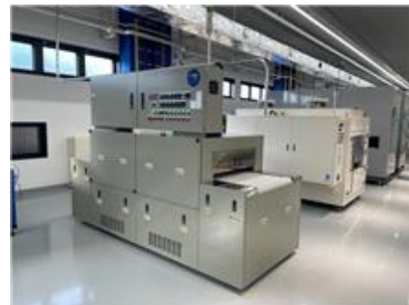
製品例2：遠赤外線アニール装置（硬化炉）
