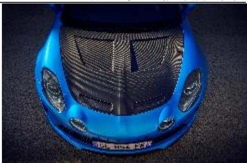
完全に炭素繊維でできているので、A110 Rのボンネットは2.9kg少ない。2つのエアダクトがスポーツカーの空気力学を最適化する。
