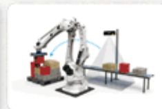
ロボットデパレタイズシステム （パレット荷下ろし自動化）
