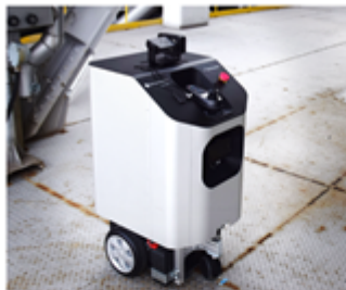
±1cm程の誤差で床面を航行し、正確なポジションから対象を撮影。搭載センサを変えることでさまざまな点検に対応。
