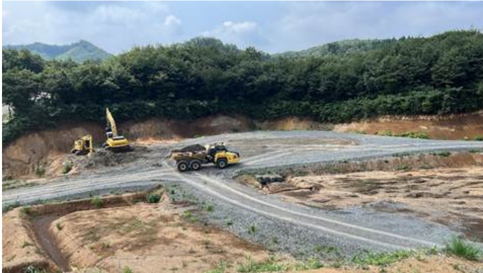
自動運転試験中のアーティキュレートダンプトラック（HM400）の走行の様子
