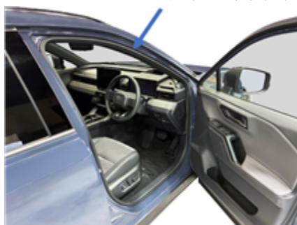
ゴムのリサイクル材を高配合したオープニングトリム
